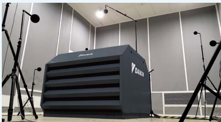
Pomiar poziomu mocy akustycznej w komorze akustycznej
