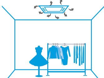
Rozkład powietrza z zabrudzonym filtrem
