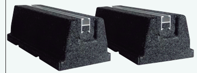
Podstawa pod jednostkę zewnętrzną absorbująca hałas i wibracje Wymiary (wys. x szer. x głęb.): 600 x 95 x 130 mm Dopuszczalne obciążenie robocze: 500 kg
